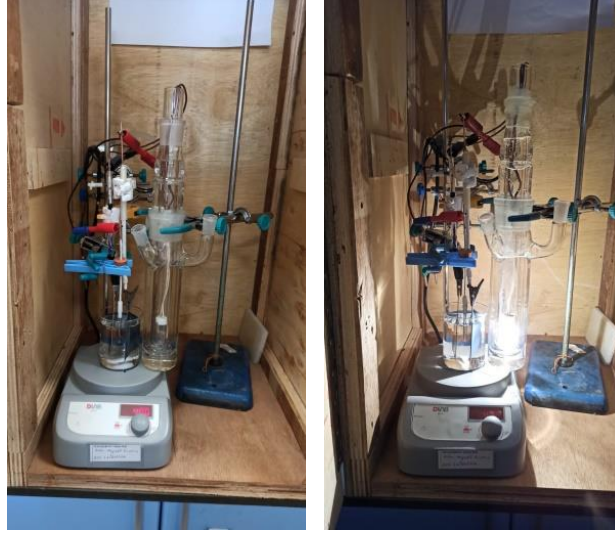
Resim 3.3 UV-GB ve GB ışık kaynakları ile yapılan FEK ve EK deney düzeneğinin resmi.
