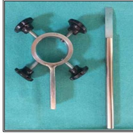
Resim 19. Universal çekme-basma cihazı Resim 20. Vidalı aparat ve düz-ince uçlu bıçak
