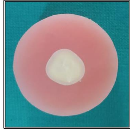
Resim 4. Akrilik rezine gömülü dentin örneği
