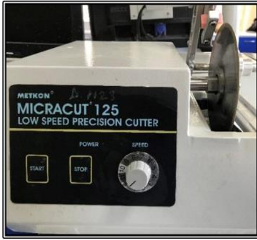
Resim 1. Düşük hızlı hassas kesme cihazı
