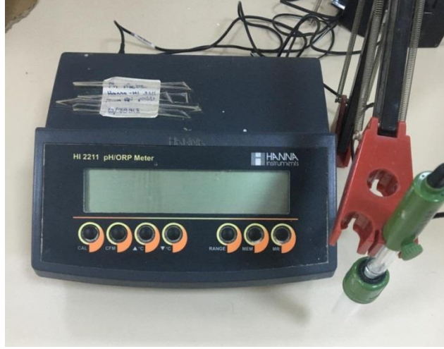
Şekil 3.6. pH metre cihazı
