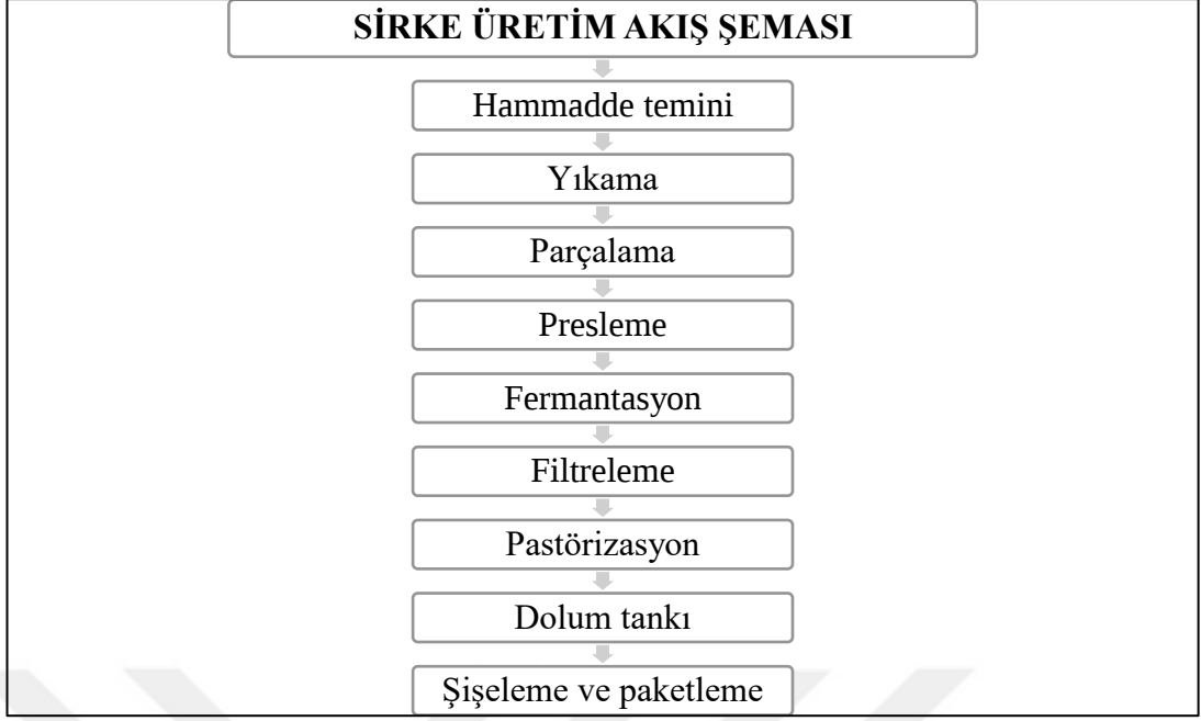
Şekil 2.2. Sirke üretim akış şeması.
