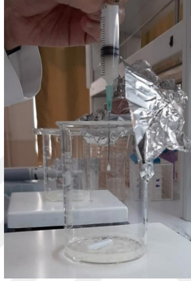
Şekil 3.3. Steril şırınga ile mikrokapsül eldesi.
