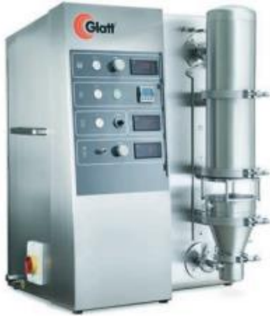
Şekil 3.3. Akışkan yatak kurutucu (Mini-Glatt, Binzen, Almanya)
