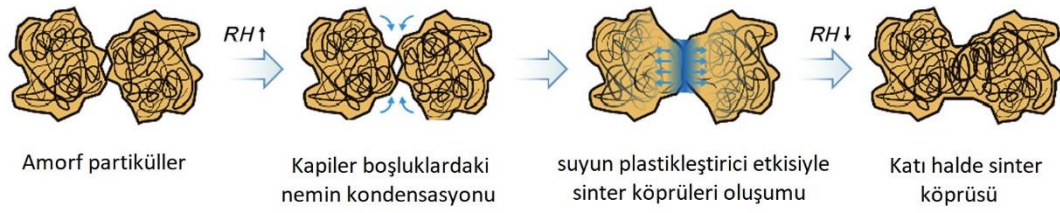
Şekil 2.7. Depolama atmosferinin bağıl nemine bağlı olarak amorf yapılarda sinter köprüsü kaynaklı kekleşme oluşumu (Chen vd. 2019)
