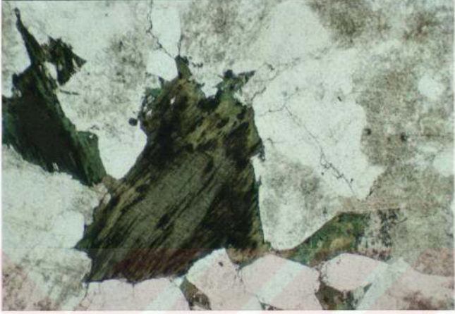
Şekil 3.11: Yan kayalarda alterasyon sonucu gelişen kloritler. NS-2 sondajı, metraj: 124.40 m (TN X 32).
