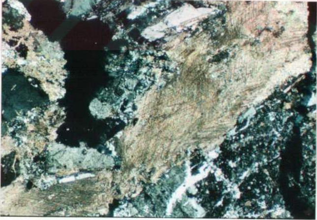
Şekil 3.12: Yan kayalarda alterasyon sonucu gelişen karbonat. NS-2 sondajı, metraj: 124.45 m (ÇN x 32).
