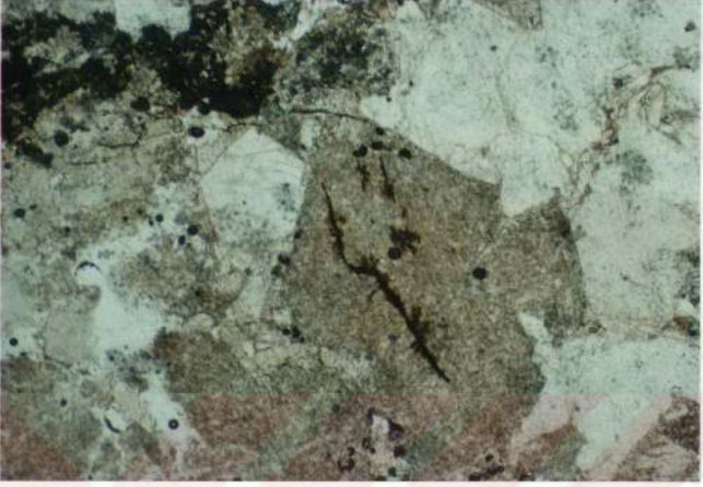
Şekil 3.9: Yankayaçlarda alterasyon sonucu gelişen serizitleşmeler. NS-2 sondaj, metraj: 108.80 m (TN X 32).
