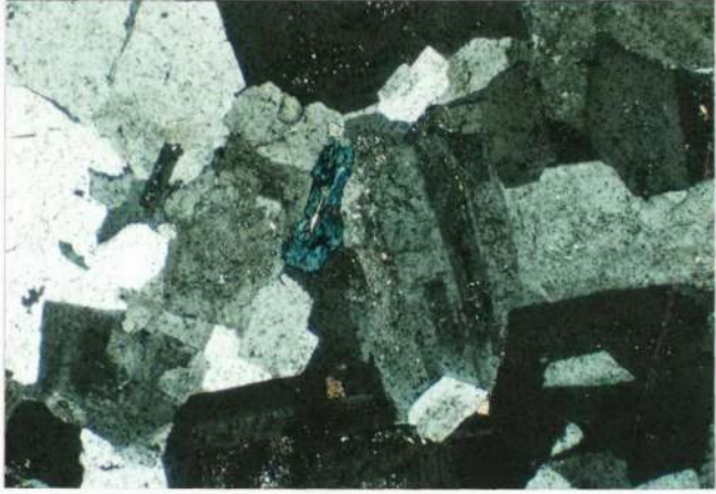
Şekil 3.13: Yan kayalarda alterasyon sonucu gelişen epidot. NS-2 sondajı, metraj: 166.75 m (ÇN X 32).
