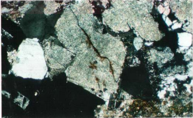
Şekil 3.8: Yan kayaçlarda alterasyon sonucu gelişen serizitleşmeler. NS-2 sondajı, metraj: 108.80 m (ÇN X 32).
