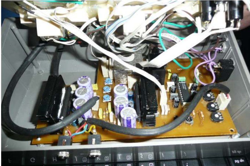
Şekil 3.1.1 – Nazometre Sistemi: (a) Tasarlanan Nazometre Sisteminin Genel Görünümü, (b) Sistemdeki Entegreler
