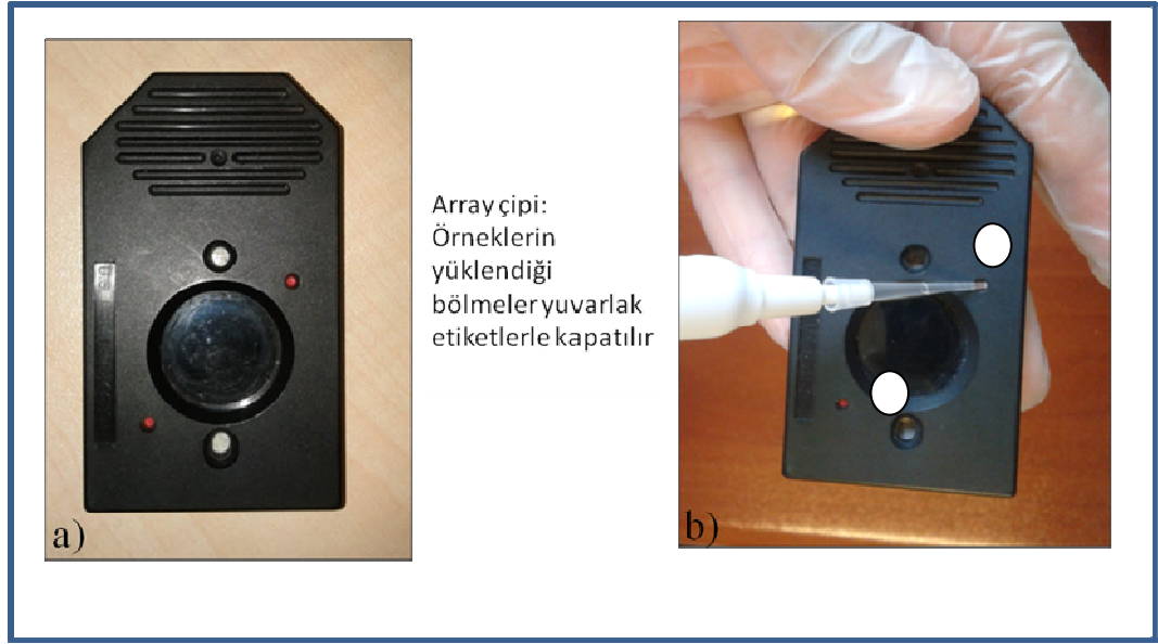
Şekil 3.5. a) Array chipinin görüntüsü b) Örneklerin küçük bölmelere yüklenişi.
