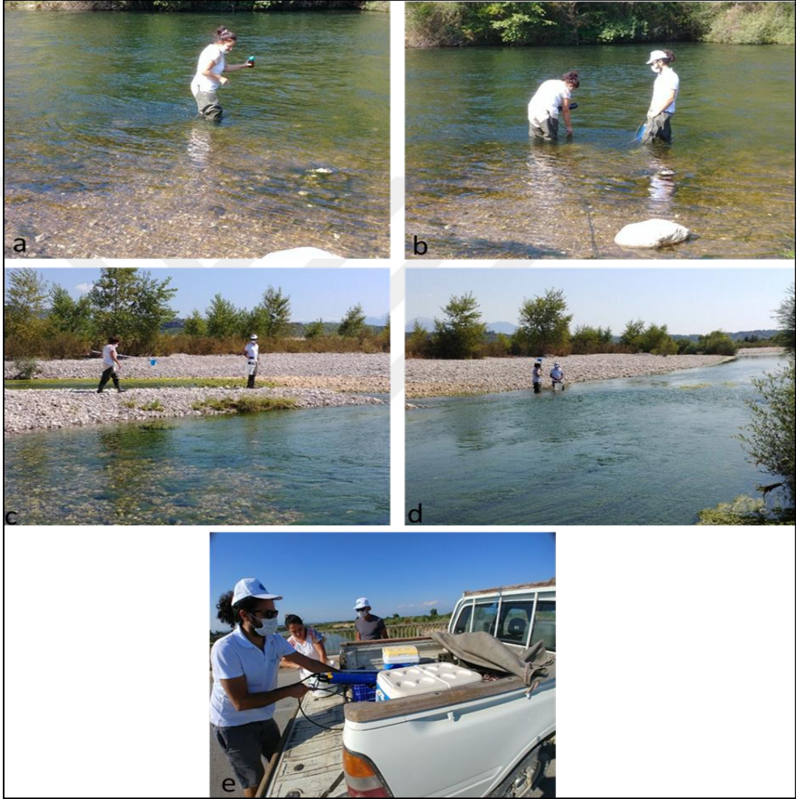
Őekil 3.9. a) Bakteriyolojik numune alımı (Aksu 1); b) Multiparametrik su kalite  l  m YSI EXO2 sonda ile saha  l  mlerinin ger ekleŐtirilmesi (Aksu 1); c); d)  rnekleme  ubuđu kompozit su numunesi alımı (Aksu 2); e) TaŐıma kapları ve sahada kullanılan cihazlar
