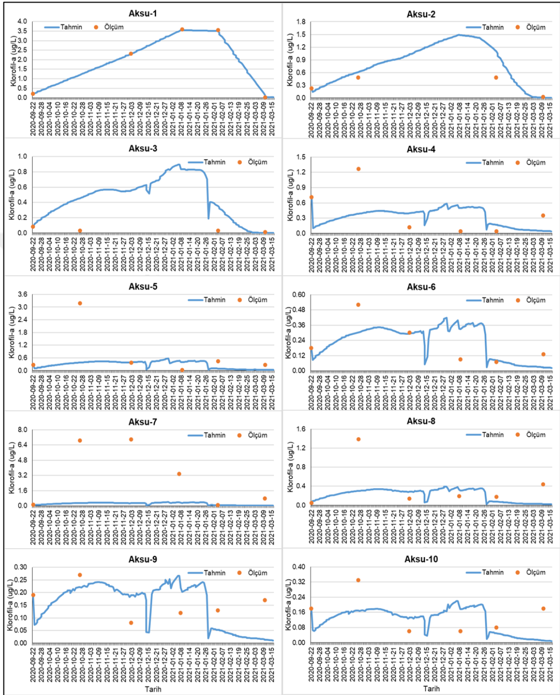
Şekil 4.20. Aksu Çayı'nın membadan (Aksu 1) mansaba doğru (Aksu 10) tüm istasyonlar için WASP8 modelinden elde edilen klorofil-a tahminleri ve ölçümleri
