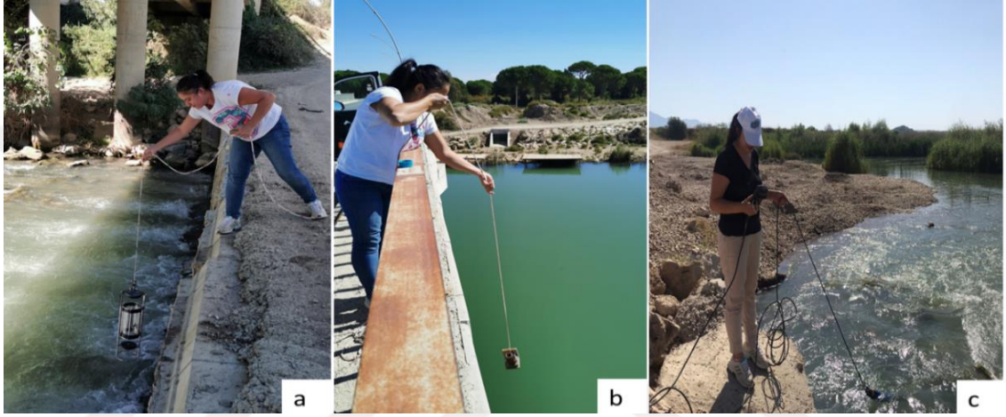
Şekil 3.13. a) Nansel şişesinin kullanımı (Aksu 8); b) bakteriyolojik numune kabı kullanımı (Aksu 10); c) YSI EXO2 Sonda cihazı kullanımı (Aksu 7)
