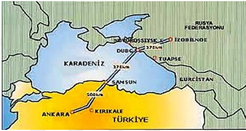
Şekil 14: Mavi Akım Boru Hattı/Samsun-Ankara Boru Hattı
