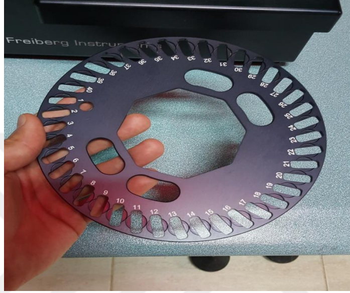
Şekil 3.4. 40 tane örnek haznesine sahip örnek tablası ve örneklerin yerleştirildiği kenarlı diskler
