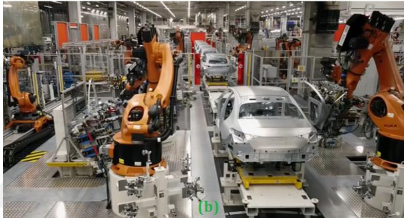
Şekil 2.4. (a) Araba gövdesi montajı adımları ve (b) üretim hattında görev yapan montaj robotları
