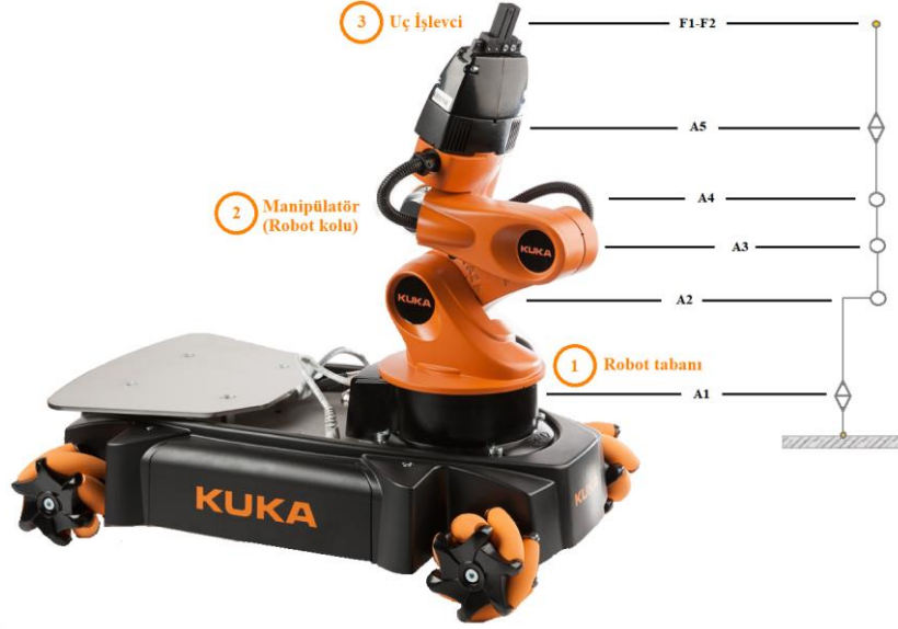
Şekil 4.21. Simülasyonda kullanılan 5 serbestlik dereceli KUKA youBot robot kolu yapısı
