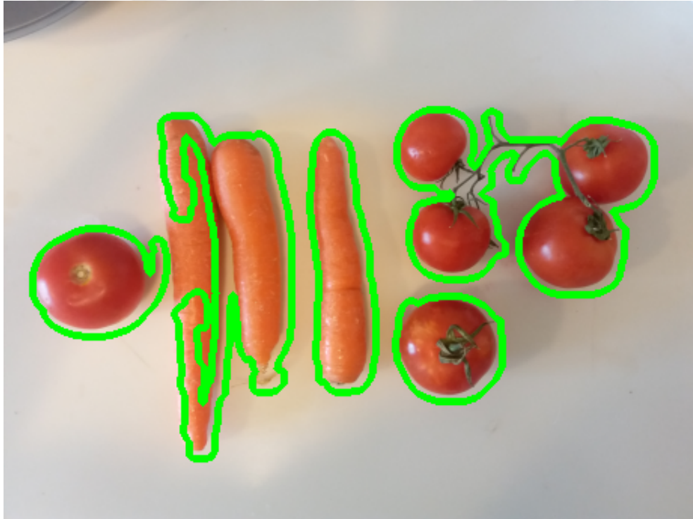
Şekil 3.16 Yeni görüntü olarak kaydedilecek nesnelerin saptanan kapalı geometrileri
