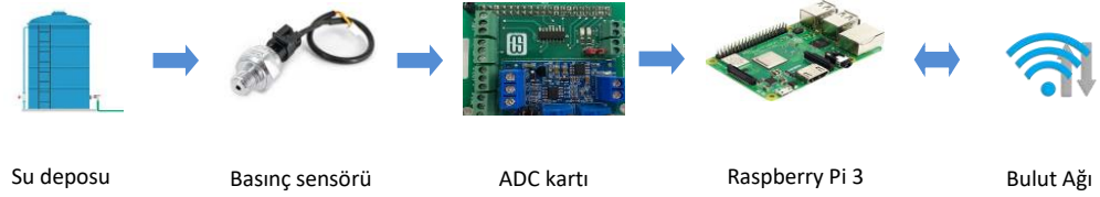
Şekil 3.13. Su deposu IoT sistemi bilgi akışı blok diyagramı
