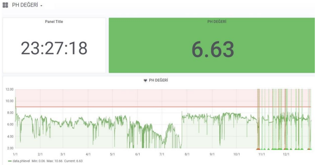
Şekil 4.5. Kimyasal üretim yapan bir fabrikanın yağmur suyu kanalına karışması muhtemel kimyasallarının pH değerinin gösterildiği Grafana ekranı
