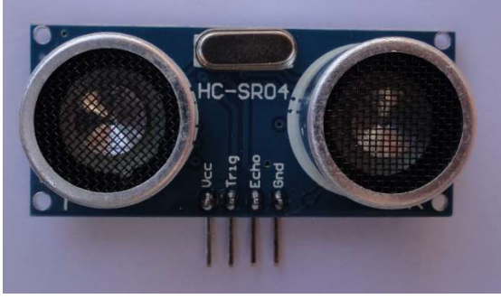
Şekil 18. Ultrasonik Mesafe Sensörü HC-SR04. Şekilde görülen kart bağlantı noktaları pozitif (+5V), negatif, tetikleme ve eko yollarıdır.
