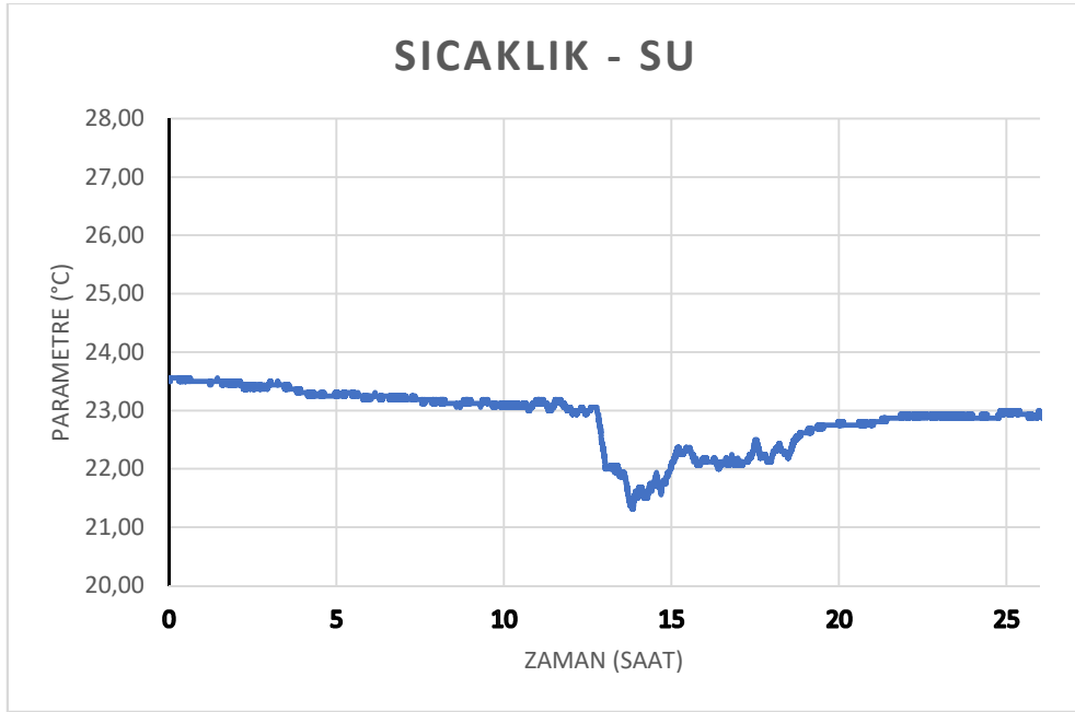
Şekil 34. Likit ortamda ölçüm yapabilen sıcaklık sensörü ölçüm zaman serisi
