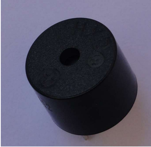
Şekil 24. Buzzer (Sesli uyarı ya da alarm amaçlı)
