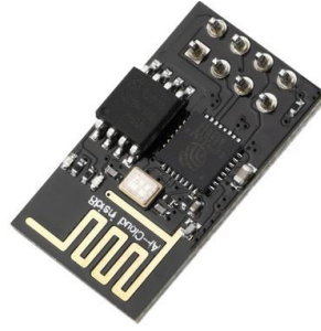
Resim 3.4. ESP8266 Wi-Fi modülü
