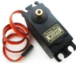
Resim 3.5. MG995 servo motor
