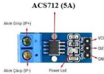
Şekil 3.8. ACS712 bacak bağlantıları
