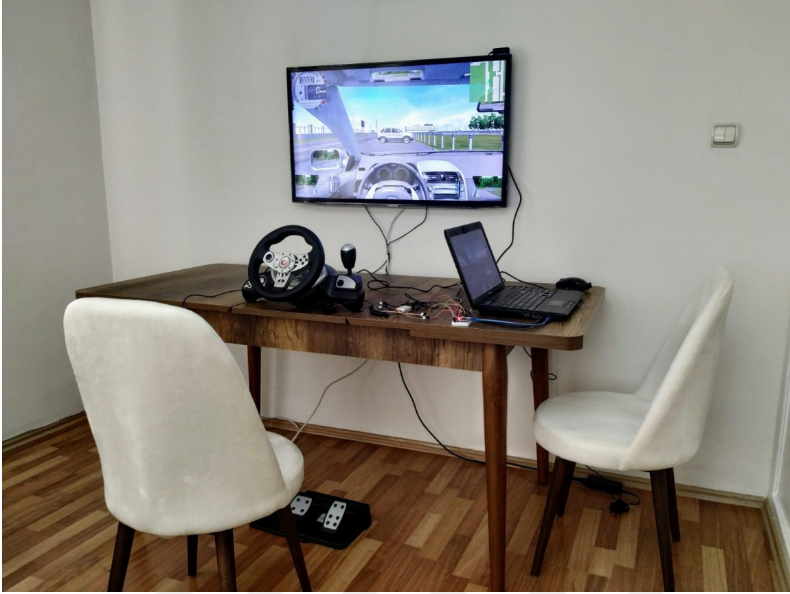
Resim 4.12. Çevrim içi sürücü durumu tespiti için hazırlanan iç mekân sürüş ortamı
