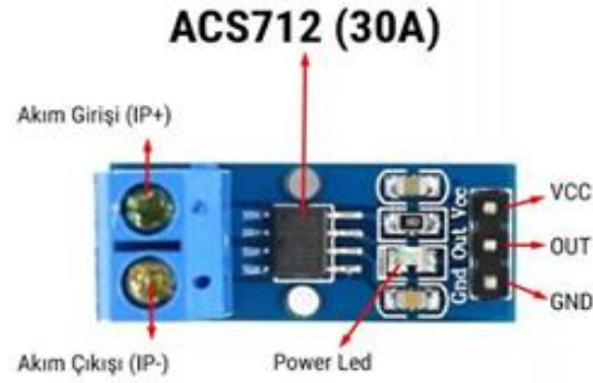
Şekil 17. ACS-712 Pin diyagramı
