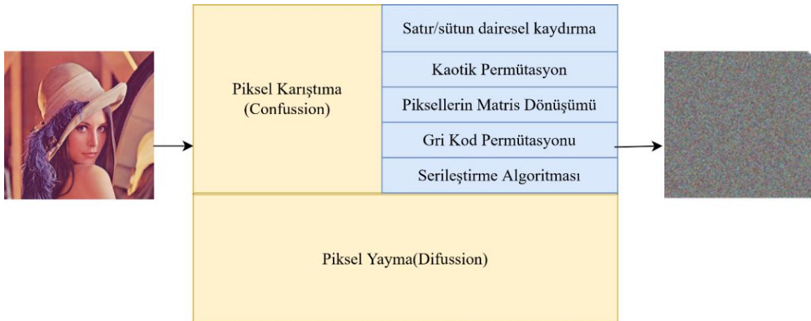
Şekil 4.3: Görüntü Şifreleme Temel Adımları (Köşe geçiş algoritması uygulanması sonrası Lena görüntüsü).
