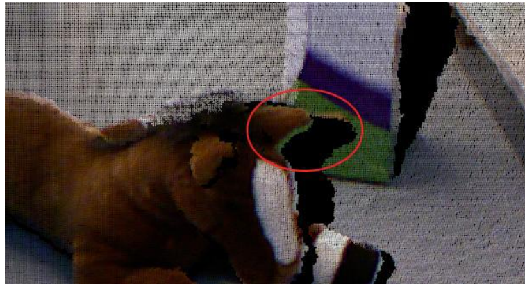
Şekil 4.5. Kinect ile elde edilen renk edinimi hatası [16].
