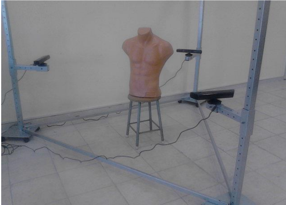
Şekil 3.2. Nesne tarama için algılayıcı konstrüksiyonu
