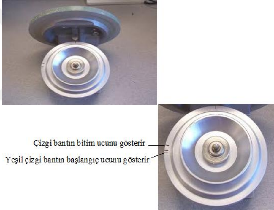
Sekil 3.3 Burkard polen tuzağının kasnağı
