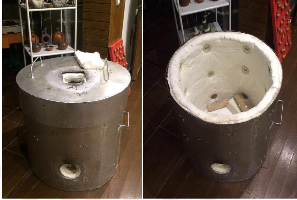
Görsel 1.23. Seramik Fiberle Yapılmış Gazlı Raku Fırını ( Seda Küçükçakır Kişisel Arşiv, 2018)
