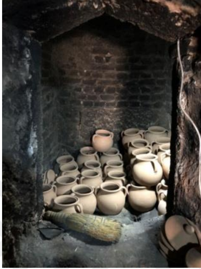
Görsel 2.12. Ürünlerin Kara Fırına Yerleştirilme Aşaması
