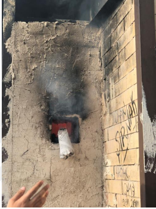
Görsel 2.40. Fırına Tuz Atılma Aşaması ( Seda Küçükçakır Kişisel Arşiv, 2019)
