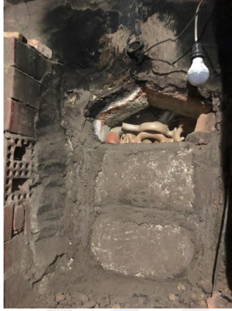
Görsel 2.19. Kara Fırın Kayacak Kapısı'nın Açılma Aşaması
