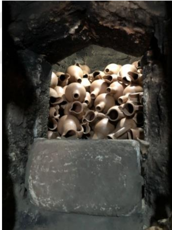
Görsel 2.14. Kara Fırın'ın Kayacak Kapısının Kapatılması
