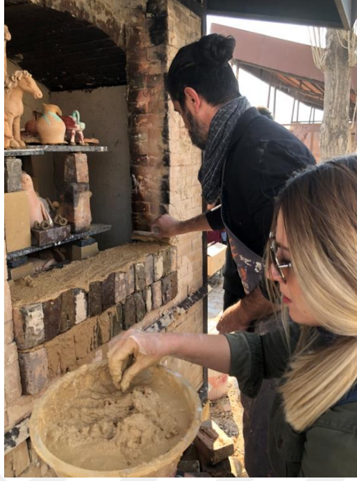
Görsel 2.36. Fırın Doldurma Kapısının Örülme Aşaması
