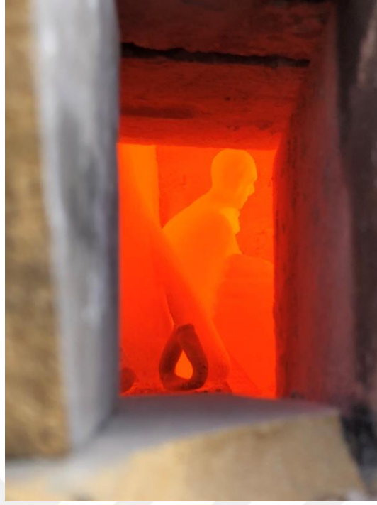
Görsel 2.42. Gözetleme Deliğinden Tuz Halkası ve Fırın İçi Görüntüsü
