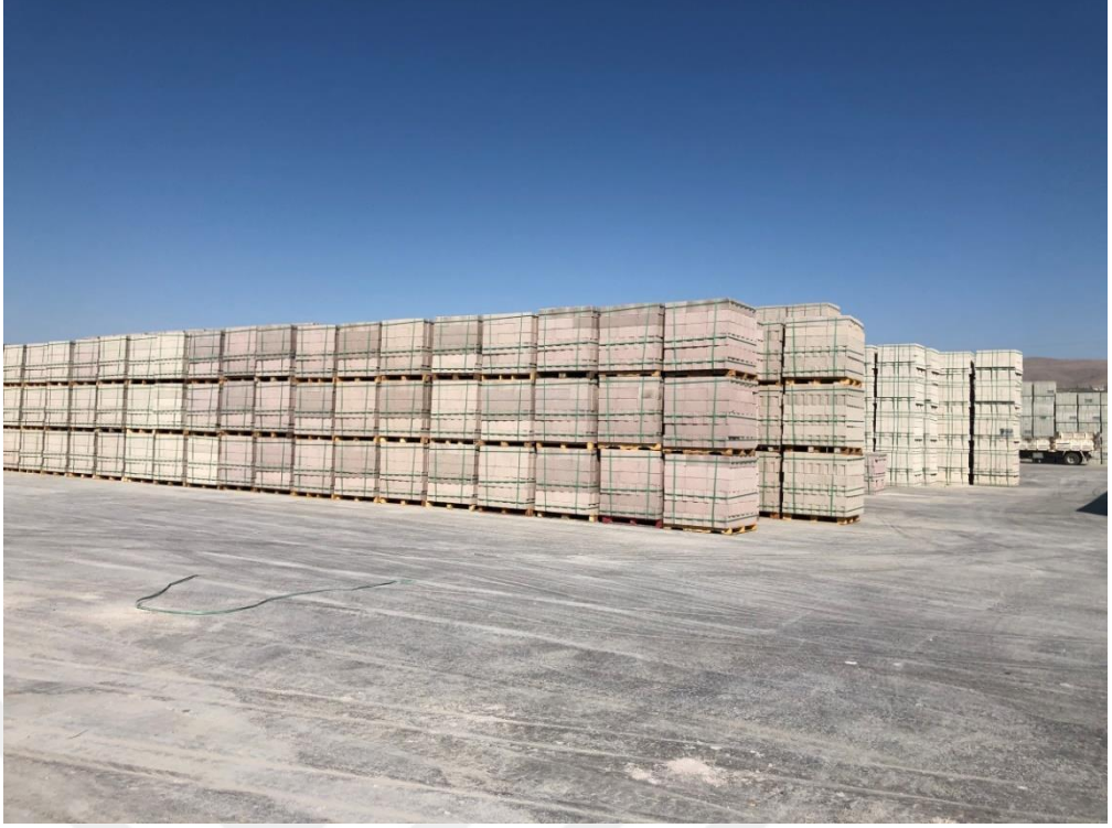
Şekil 3.23. Düzenli istiflemenin yapıldığı stok sahası doğru uygulama örneği.
