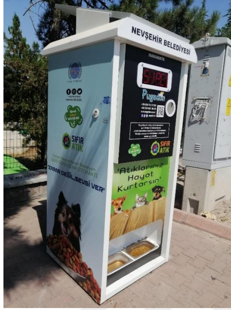
Şekil 4.3 Atık atıldığında hayvanlar için su ve mama veren teşvik edilmesi amaçlanan akıllı geri dönüşüm kutusu.
