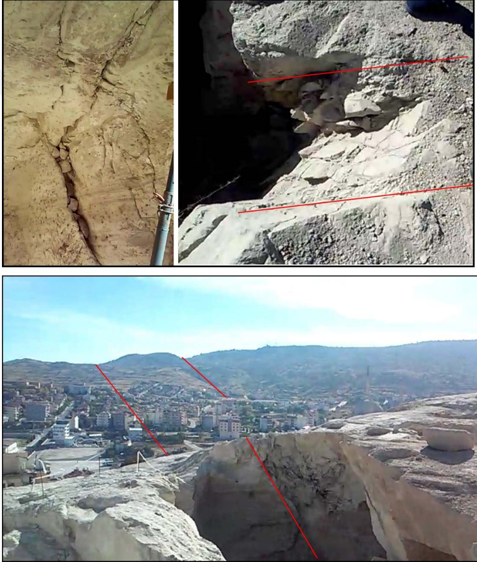
Fotoğraf 40. Oylu Dağında Uzantısı Gözlenebilen Ters Fay ve Kaleye Etkisi
