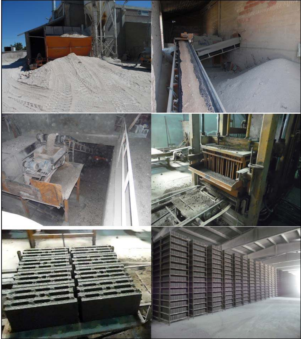
Fotoğraf 34. Bims (Pomza Agregası) Üretim Aşamaları.
