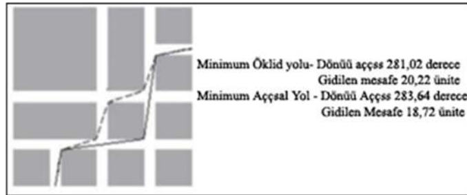
Şekil 13. Minimum Öklid Yolu ve Minimum Açısal Yol
