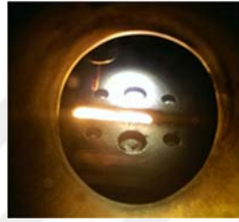
Şekil 5.2 : Akkor olana kadar eritilen numunenin fotoğrafı
