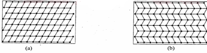
Şekil 3.5 : Kayma (a) ve ikizlenme (b) mekanizmasının şematik gösterimi [12]
