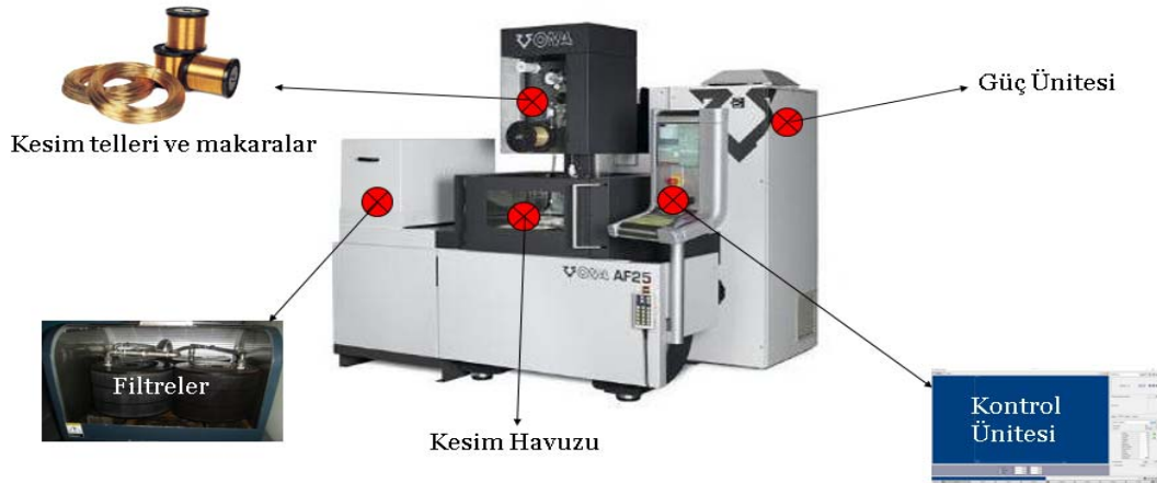
Şekil 5.4 : ONA AF25 marka ve model CNC tel erozyon tezgâhı ve kısımları
