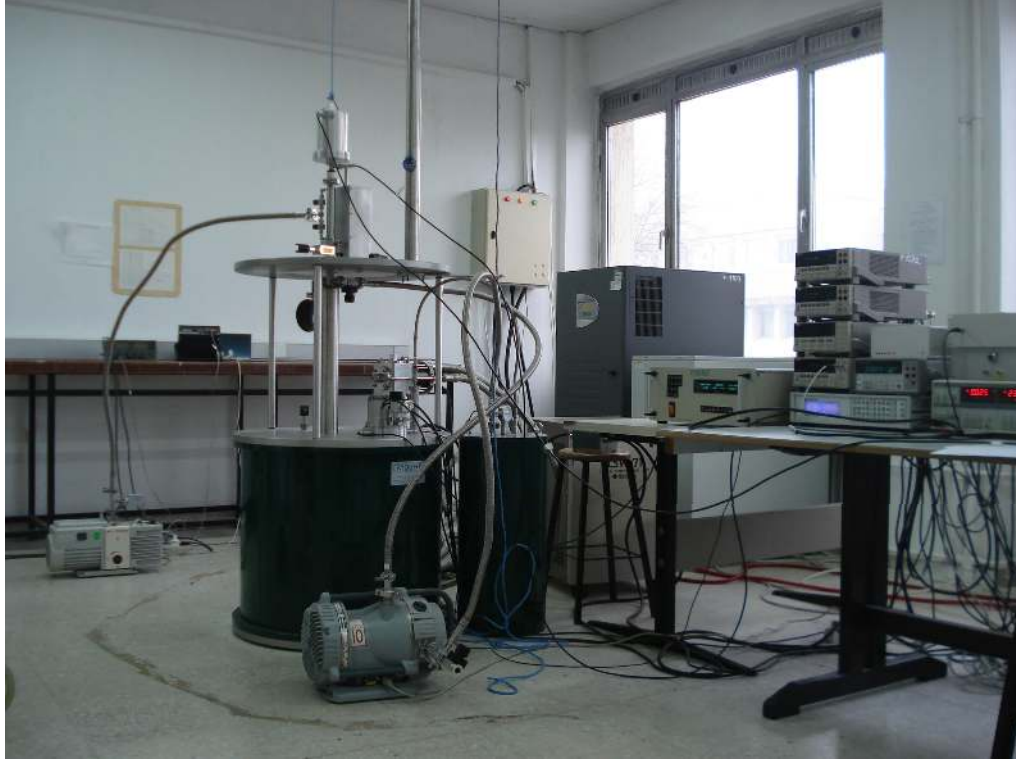
Şekil 3.4. VSM (Vibrating Sample Magnetometer) sisteminin fotoğrafı.
