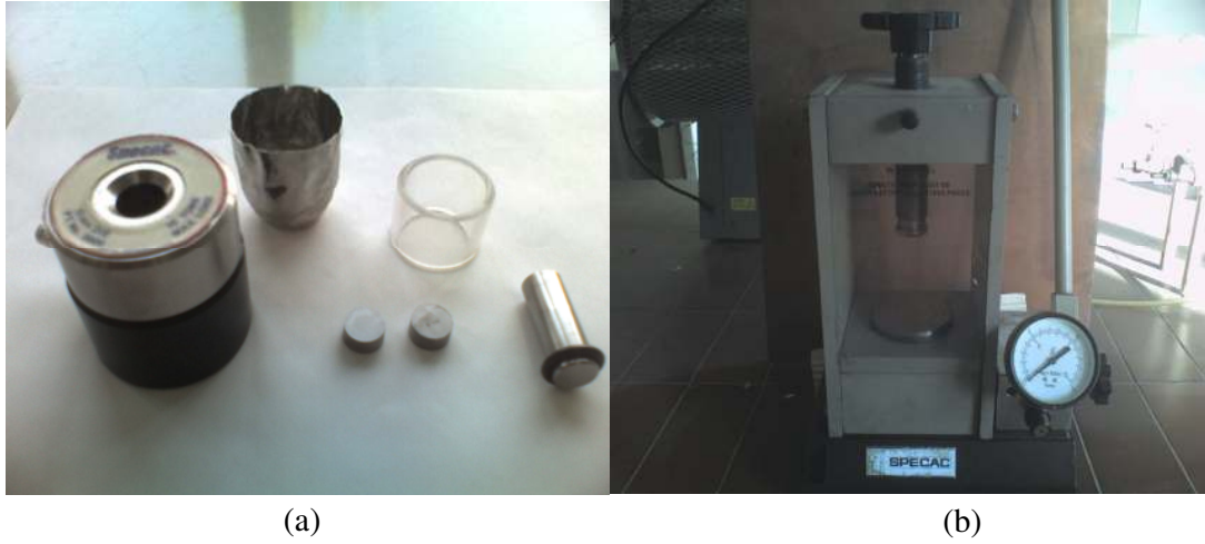
Şekil 3.3. (a)Numune hazırlama için kullanılan peletleme sistemi,(b) maksimum 15 ton kapasiteli presleme sistemi.
