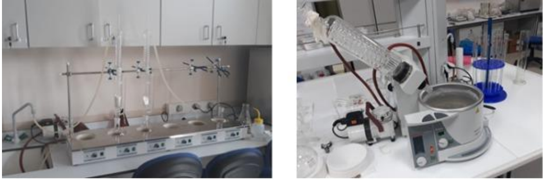
Şekil 3.24. Soxlet ekstrasyonu ve hekzan geri kazanımı.
