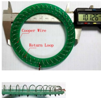
Şekil 2.26. [14]'de Yazarların tasarlamış olduğu hibrit BDK bobini
