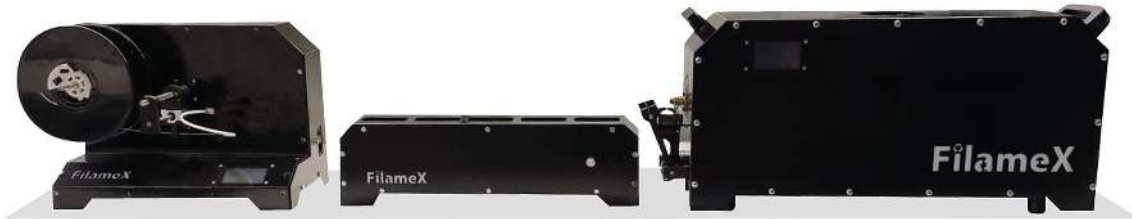
Şekil 4.6. Tez çalışmamızda nüve tasarımında kullanılan tek vidalı ekstruder sistemi
