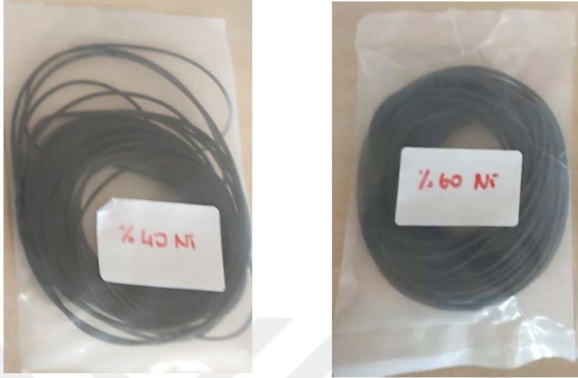
Şekil 4.7. Üretilen %40 ve %60 nikel alaşımlı filamentler
