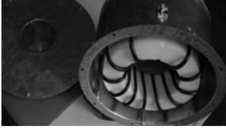
Şekil 1.7. [12]'de tasarlanan rijit rogowski bobini örneği
