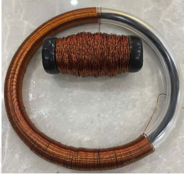
Şekil 4.11. 0.4 Mm çapında bakır tel ile sarılan esnek RB nüvesi
