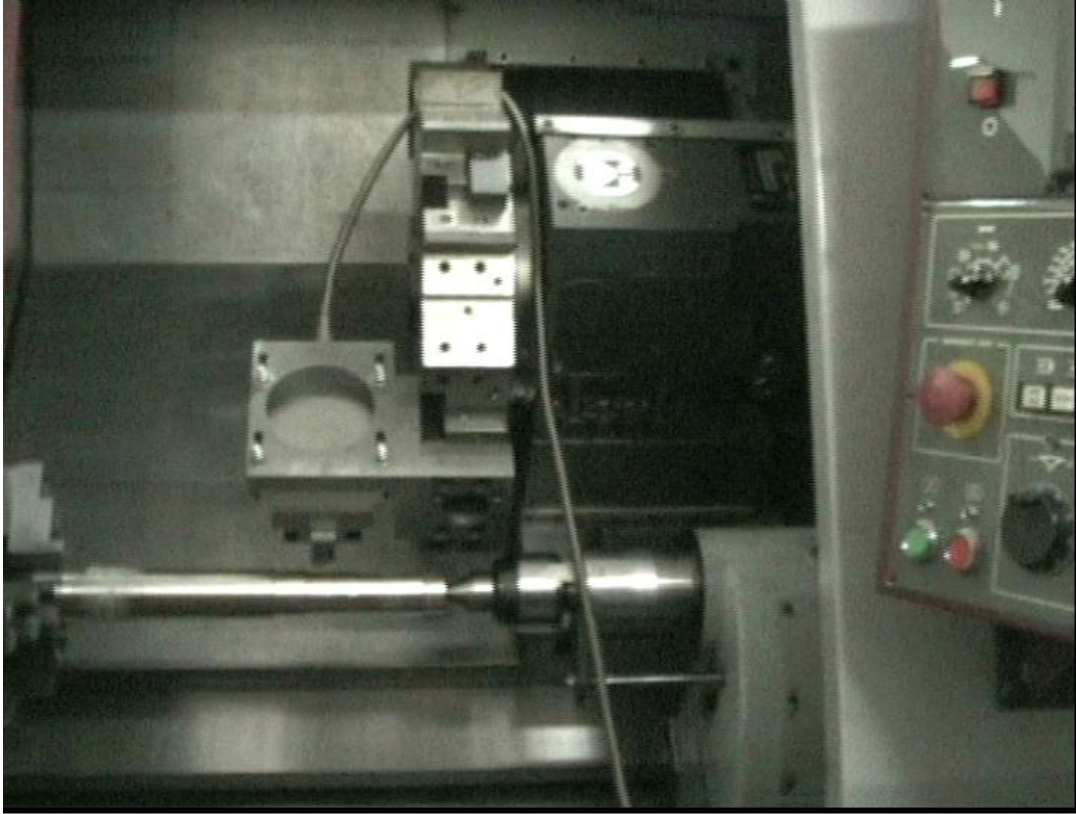
Resim 5.3. Inconel 718' i işlerken oluşan kesme kuvvetlerinin Kistler 9257B (1997) dinamometre ile Johnford T35 CNC (10 KW) torna tezgahında ölçme deney düzeneği (GÜTEF Mak. Lab.)
