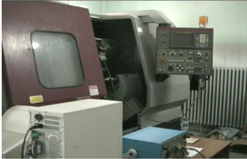
Resim 5.2. Kuvvet ölçme sisteminde kullanılan kistler dinamometre, CNC Johnford T35 torna tezgahı ve PC ünitesi (GÜTEF Mak.Lab.)
