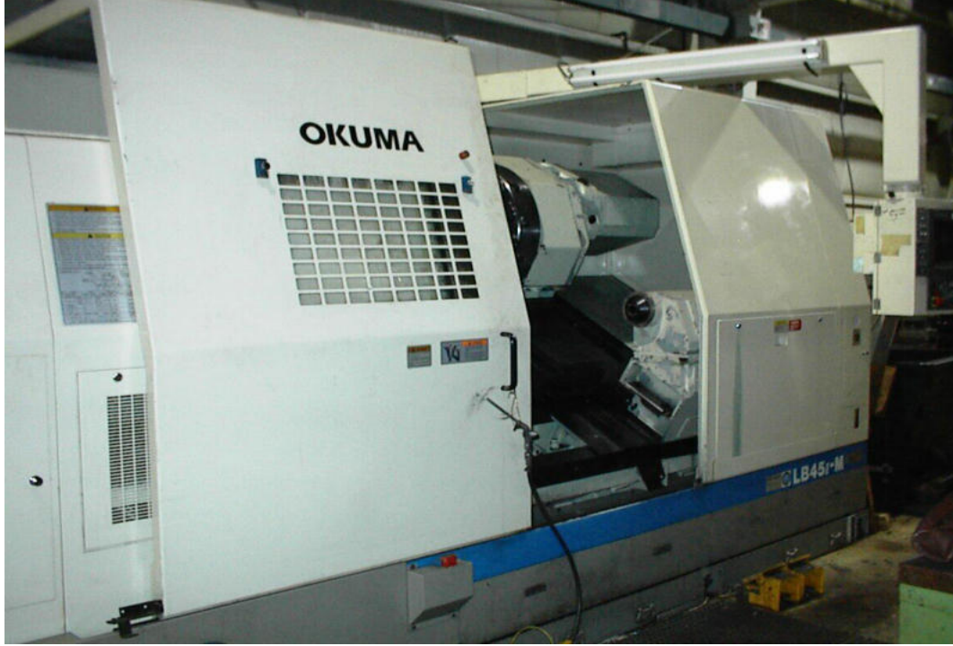
Resim 5.1. Aşınma deneylerinde kullanılan CNC okuma 45 LB torna tezgahı (TUSAŞ atelyeleri)
