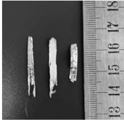
Resim 3.6 Uzun şeritler halinde üretilen yığınlardan alınan şerit döküm numunelerinin görüntüsü.
