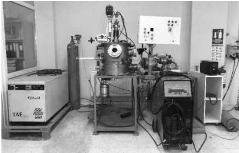
Resim 3.3 Ergitme ve dkm iřlemlerinin yapıldıęı vakum ortamlı ark ocağının grnts.
