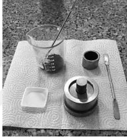
Resim 3.1 Mekanik olarak karıştırılmış tozlar ve şekillendirme işleminde kullanılan kalıbın görüntüsü.
