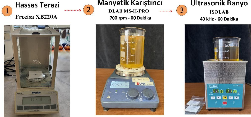
Şekil 4.5. Test yakıtlarının üretim aşamaları
