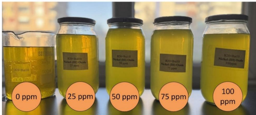
Şekil 4.7. B20But10+ Ni 2 O 3 yakıt numuneleri
