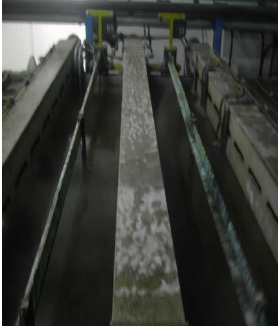
Şekil 4.2 Kale Kilit kaplama tesisi nikel banyosu
