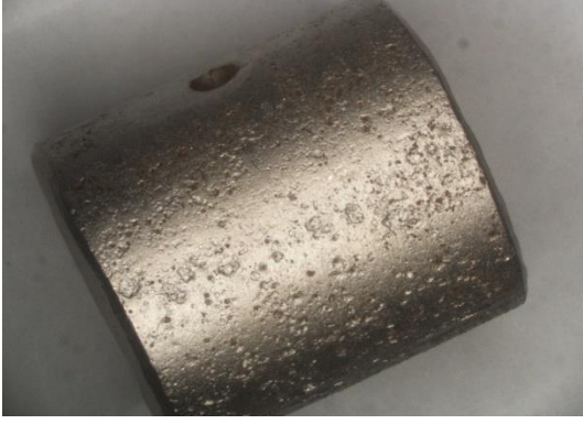
Şekil 6.30. 10 gr/L oranında borik asit ilaveli, 45°C sıcaklıkta yapılan Nikel kaplamanın tuz korozyon testi sonuçları.
