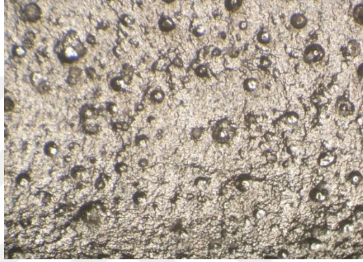
Şekil 6.31. 20 gr/L oranında borik asit ilaveli, 45°C sıcaklıkta yapılan Nikel kaplamanın tuz korozyon testi sonuçları.
