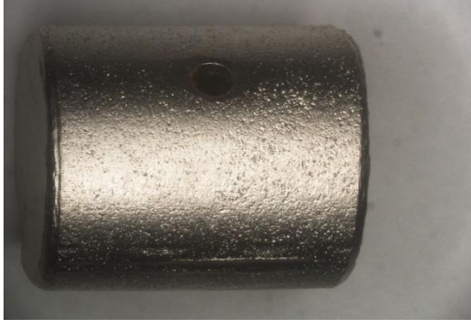
Şekil 6.33. 60 gr/L oranında borik asit ilaveli, 45°C sıcaklıkta yapılan Nikel kaplamanın tuz korozyon testi sonuçları.
