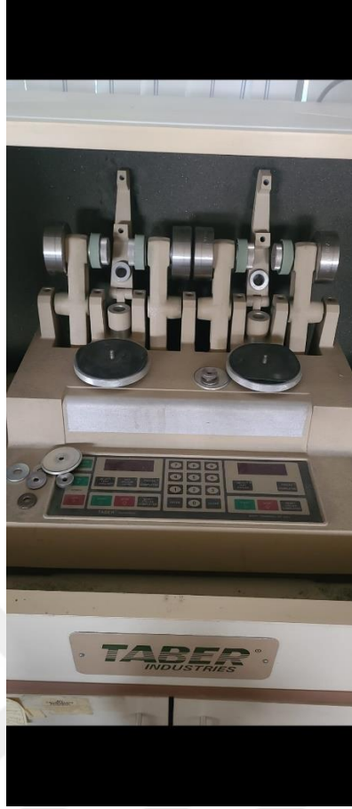
Şekil 5.5. Taber Abraser aşınma cihazı görüntüsü.
