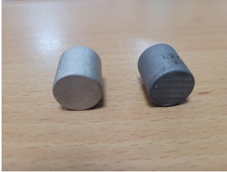
Şekil 5.2. Deneyisel çalışmalarda kullanılan numunelerin Nikel kaplama öncesi ve sonrası görüntüleri.
