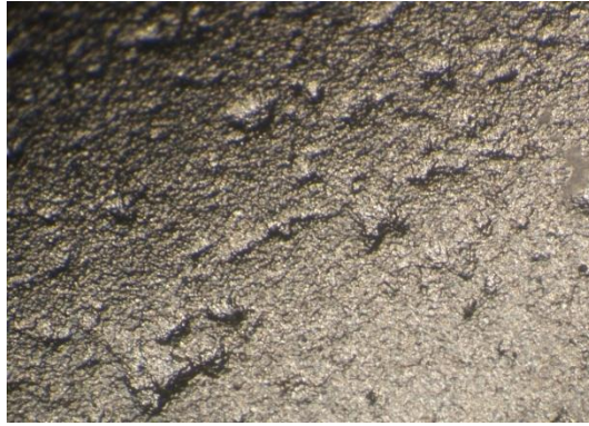
Şekil 6.32. 40 gr/L oranında borik asit ilaveli, 45°C sıcaklıkta yapılan Nikel kaplamanın tuz korozyon testi sonuçları.
