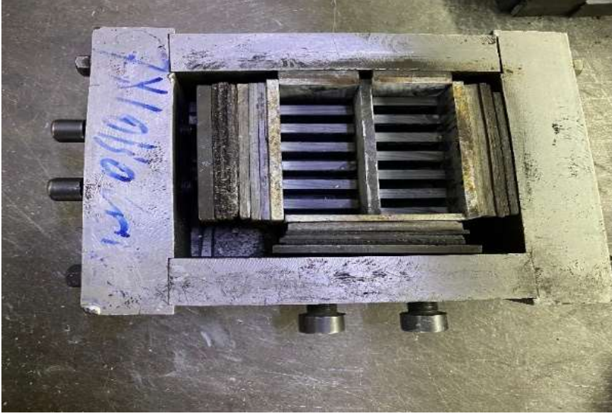
Şekil 3. 4. Numunelerin sinterlendiği grafit kalıp
