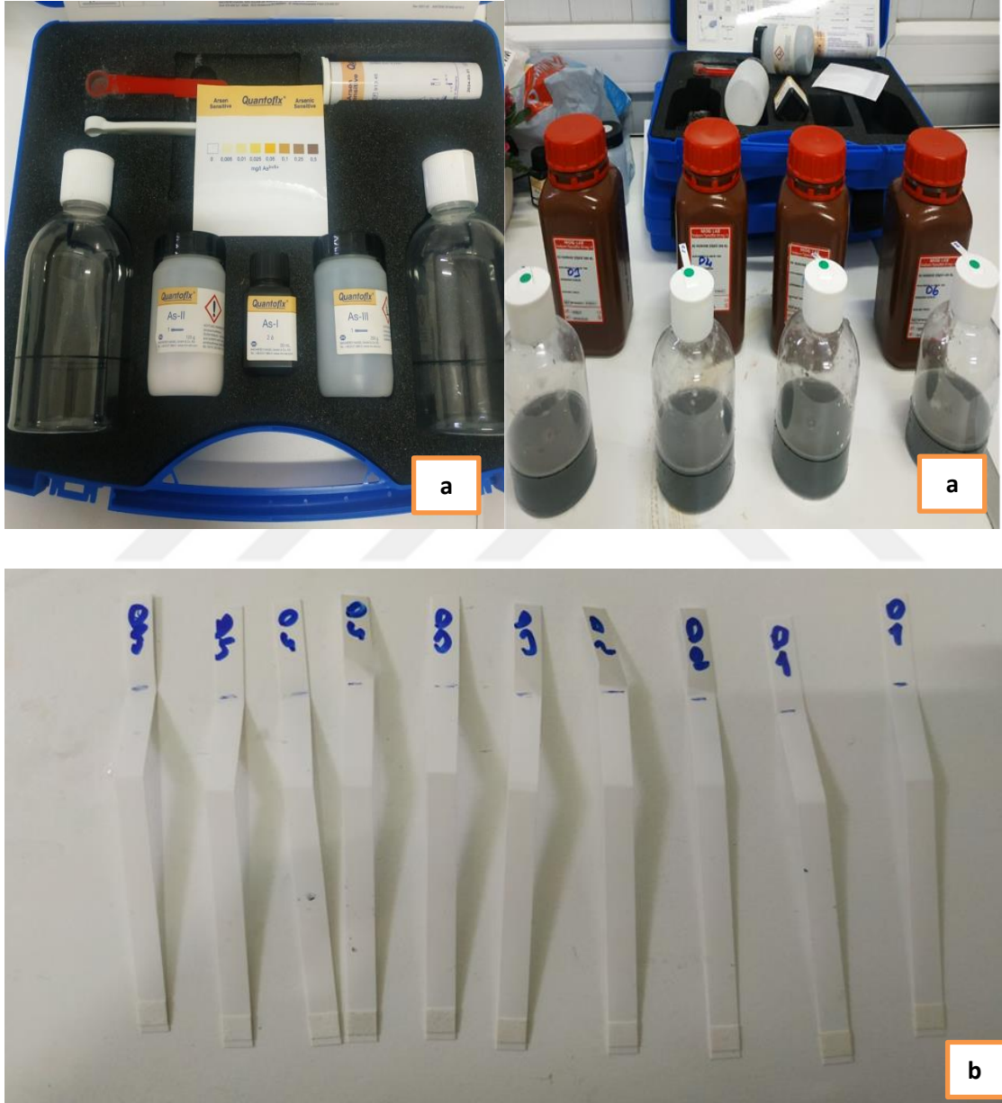
Şekil 4. 7. Arsenik analiz malzemeleri (a) ve analiz sonucu ölçüm çubukları (b)
