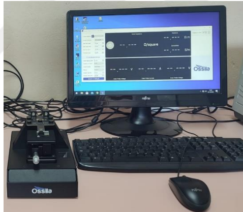
Şekil 14. Dört noktalı prob (FPP) ölçüm cihazı
