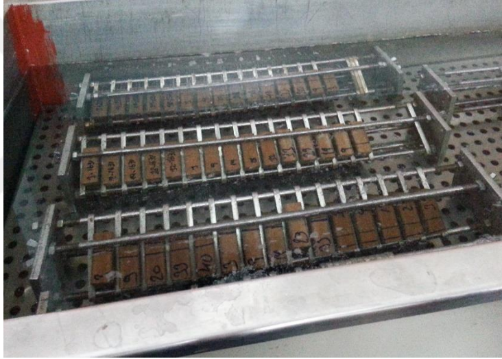
Şekil 2.2. Su alma ve kalınlık artımı testi için parçaların suda bekletilmesi.
