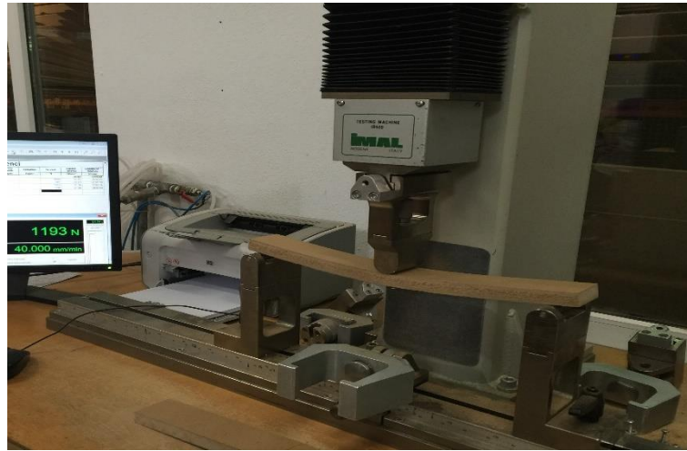
Şekil 2.3. Eğilme direnci testinin yapılışı.
