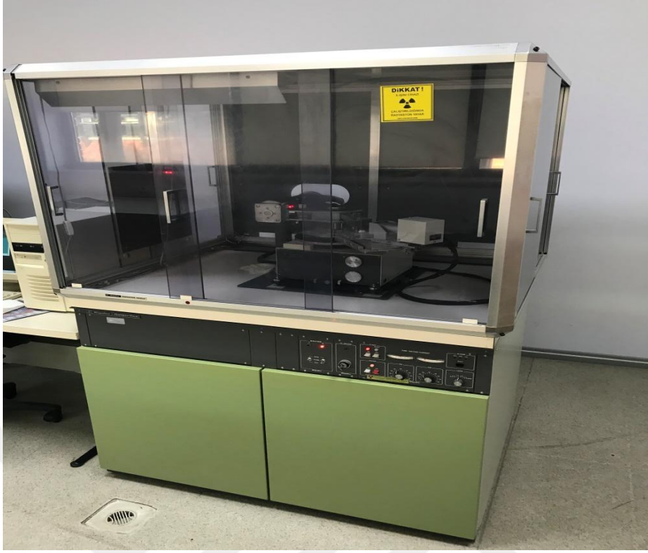
Şekil 3.8. Bu çalışmada kullanılan Bruker Discover D8 (XRD) analiz sistemi
