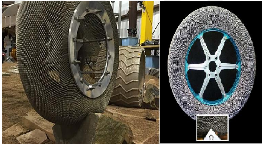
Şekil 2.19. NASA tarafından geliştirilen SMA yapılı esnek lastik [79]
