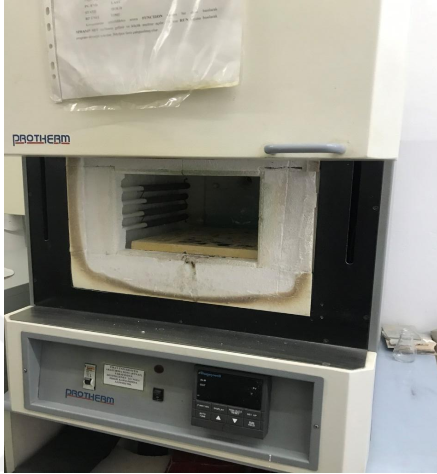
Şekil 3.2. Bu çalışmada kullanılan Protherm CWF-1200 marka kül fırını
