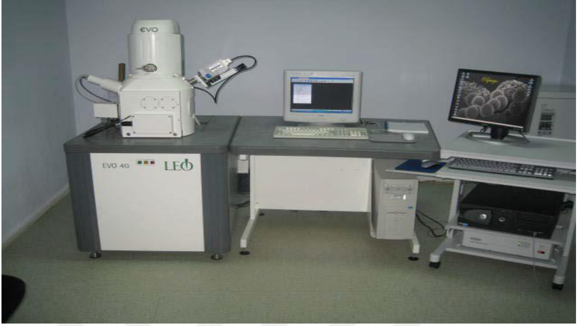
Şekil 3.6. Bu çalışmada kullanılan SEM (LEO, EVO 40, England Cambridge) cihazı
