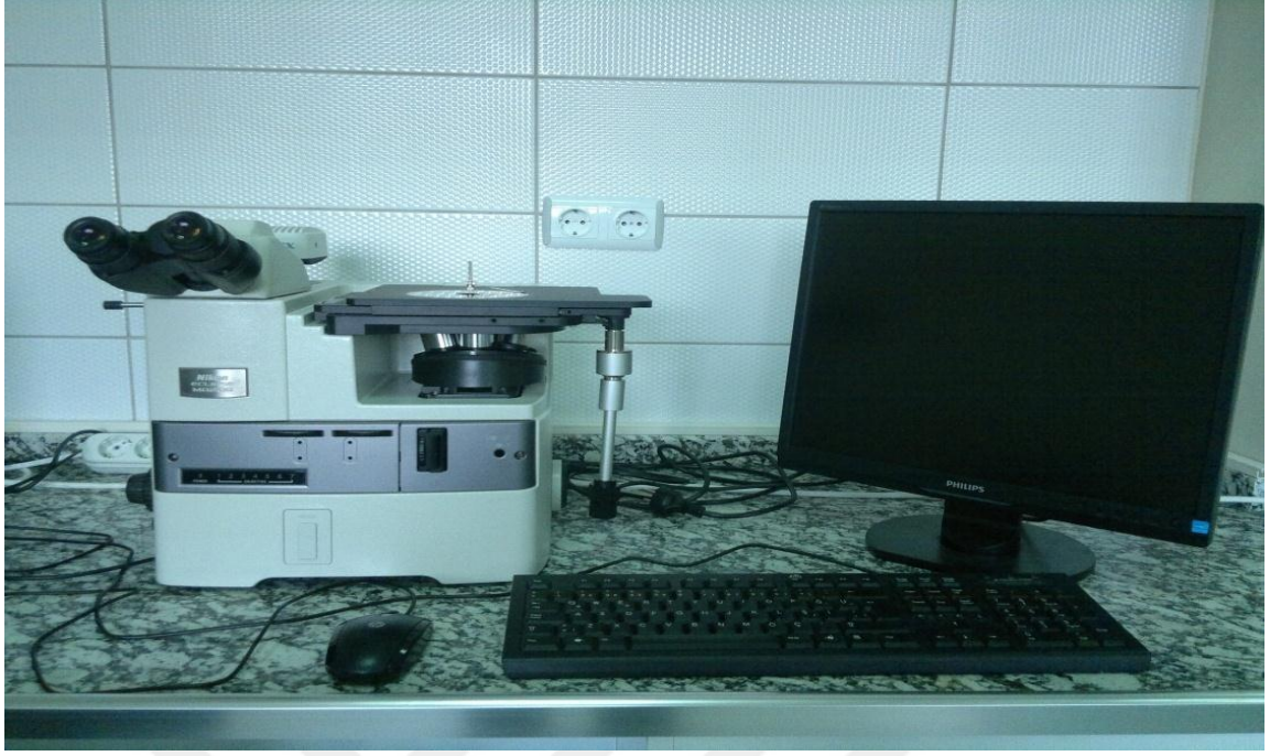
Şekil 3.5. Metalografik gözlemlerin yapıldığı Optik Nikon MA 200 Optik Mikrograf cihazı
