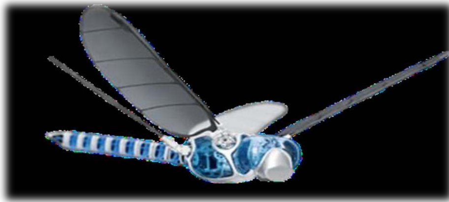
Şekil 2.20. Festo BiyonikOpter - Yusufçuk uçuşu ilham alınarak üretilmiş [87]
