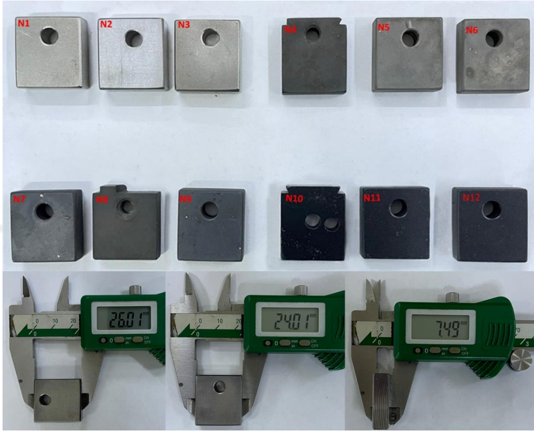
Şekil 9. Ham mamulden kesilen numaralandırılmış deney test parçaları
