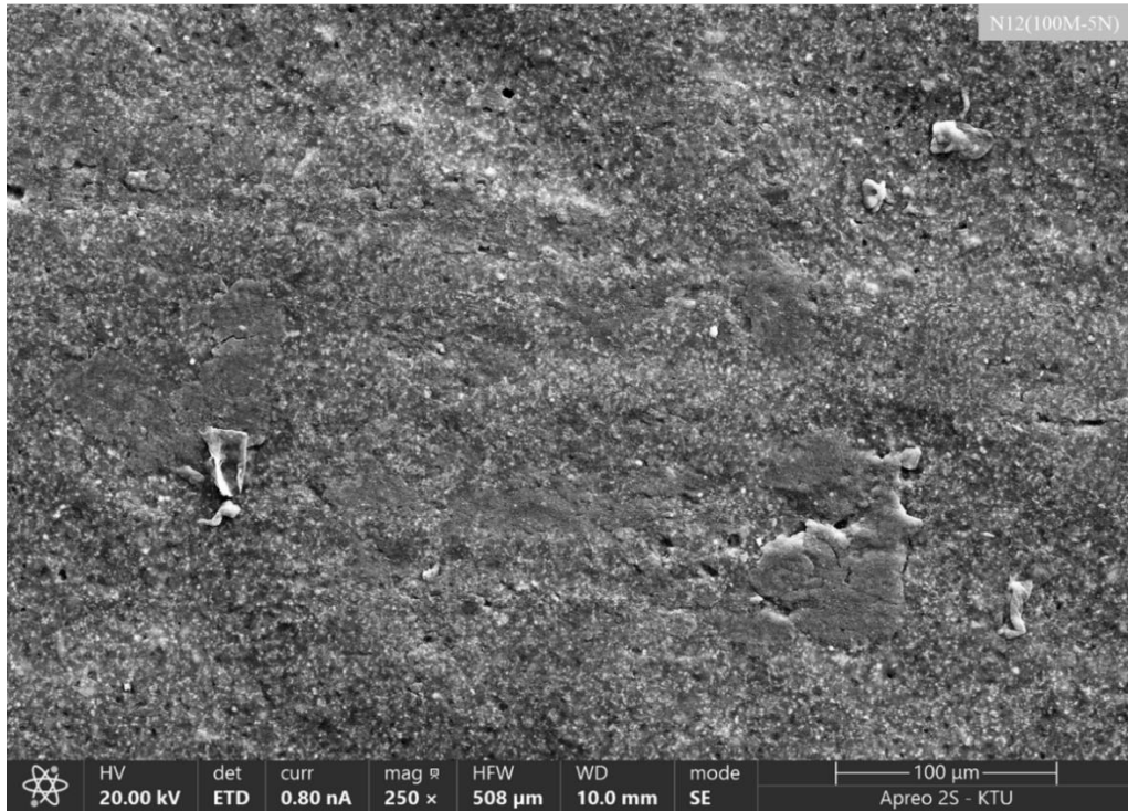
Şekil 86. N12 numunesinin 100M-5N (mesafe-yük) aralığında aşınma izi SEM görüntüsü
