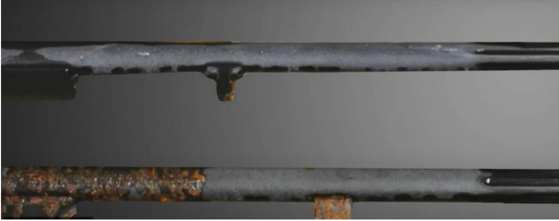
Şekil 8. İki farklı namlu malzemesine uygulanan korozyon testi sonucu ( Cerakote )
