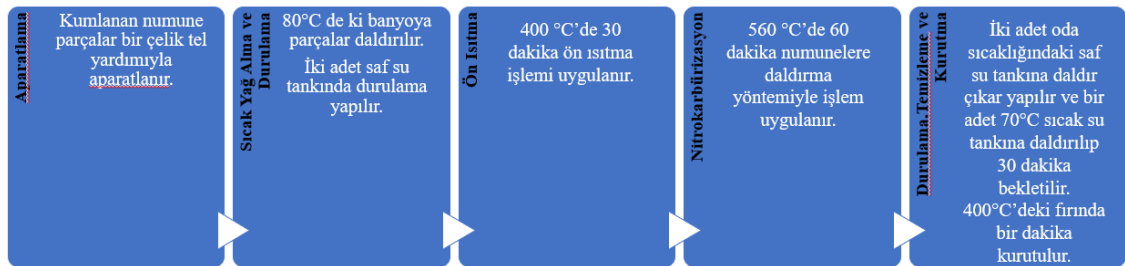
Şekil 14. Nitrokarbürizasyon prosesinin şematik gösterimi
