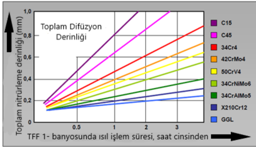
Şekil 5. Çeşitli çeliklerin toplam nitrürleme derinliğinin işlem süresine göre değişimi (GmbH)
