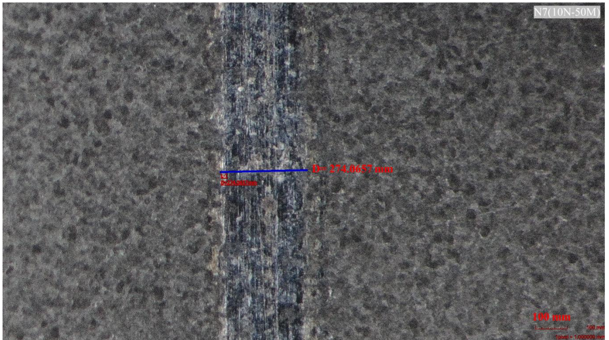
Şekil 51. N7 Numunesinin 10N kuvvet uygulanarak 50 metre mesafedeki aşınma izi görüntüsü
