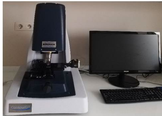
Şekil 3.4. 3D optik mikroskobu (profilometre) (Seçer, 2019)
