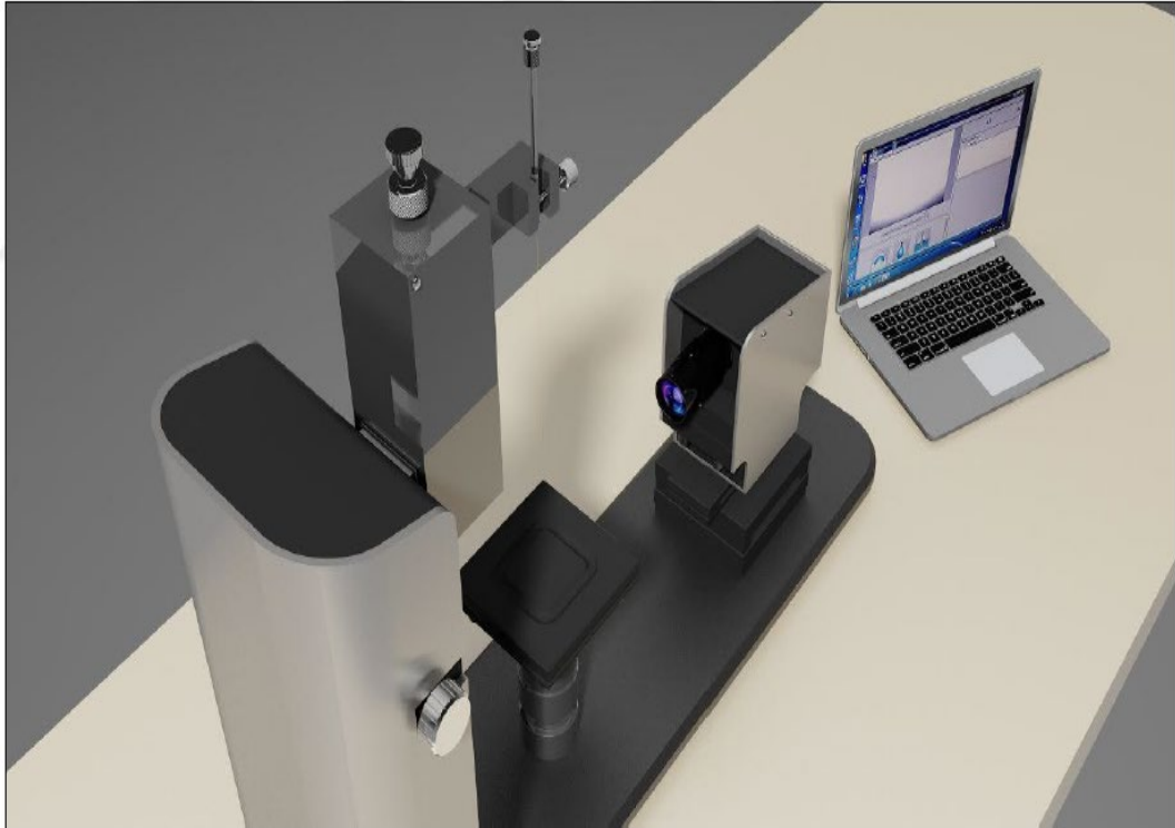
Şekil 3.6. Temas açısı ölçüm cihazı (Aslan, 2017)
