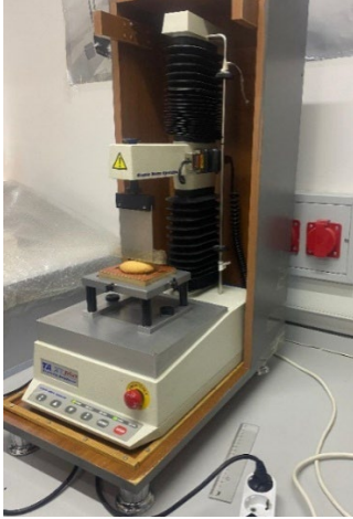
Şekil 3.8. TA-XT Plus Cihazı ile Bisküvi Ölçümü
