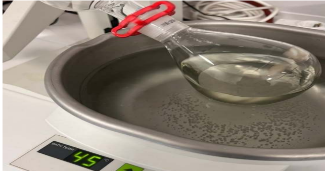
Resim 3.13: Rotary evaporator yardımıyla metanol çözeltisinin uzaklaştırılması
