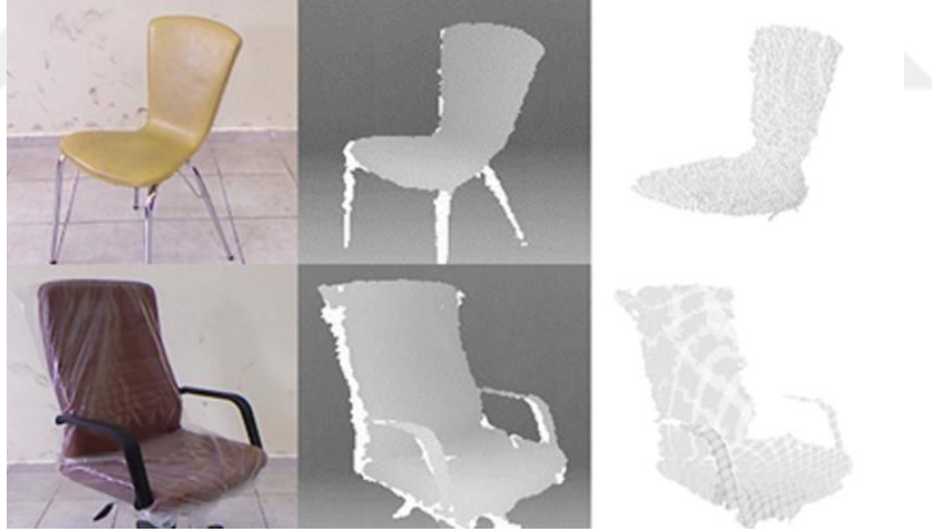
Şekil 3.7. Kinect ile yakalanmış RGB, derinlik ve nokta bulutu görüntüleri
