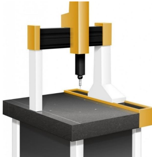
Şekil 2.1. Sert dik bir kola sahip bir koordinat ölçme makinesi [12].
