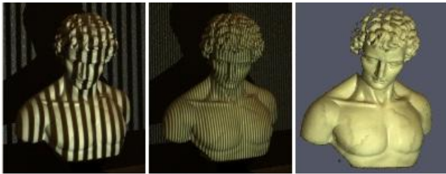
Şekil 2.5. Yapısal ışık yöntemi kullanılarak oluşturulan 3B model [18].
