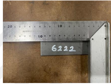
Şekil 4.3. DC04-HRP6222 Sacların 100 mm kesilmesi
