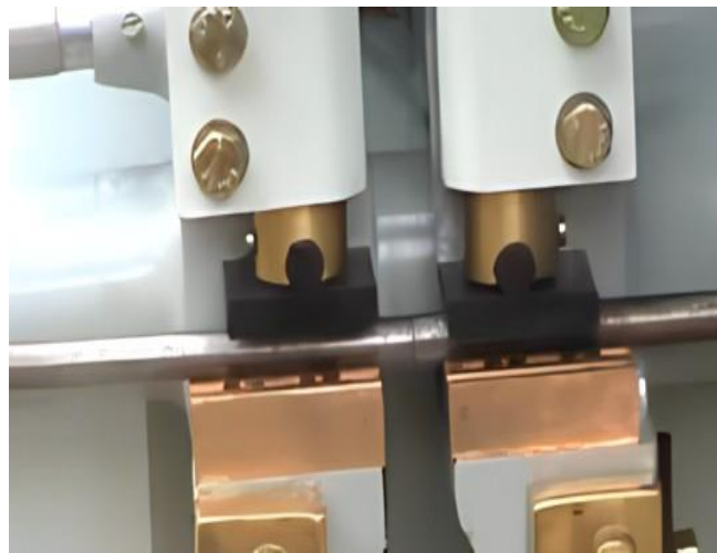
Şekil 3.3. Ön ısıtmasız yakma alın kaynağında malzemelerin bağlanması
