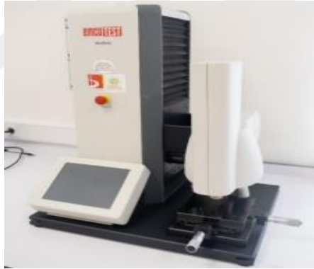
Şekil 4.12. EMCOTEST DUROSCAN 20 mikro sertlik ölçüm cihazı
