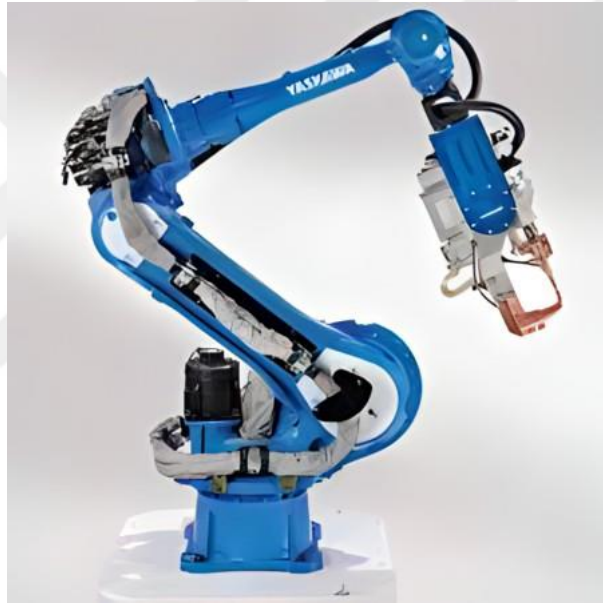
Şekil 3.13. Robot kollu nokta direnç kaynak makinesi
