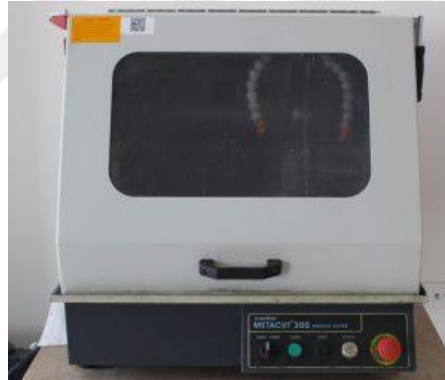
Şekil 4.9. METKON METACUT-300 hassas kesme cihazı
