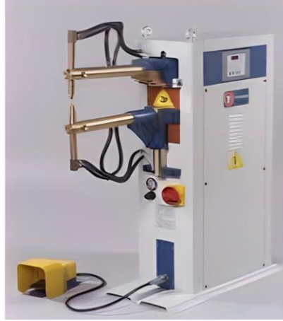
Şekil 3.10. Mekanik nokta direnç kaynak makinesi
