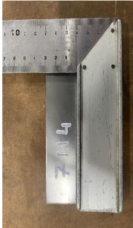
Şekil 4.4. DC04-HRP6222 Sacların 30 mm kesilmesi
