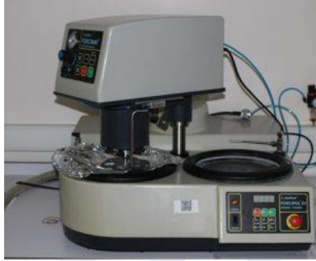
Şekil 4.10. MEKTON FORCİPOL 2V zımparalama ve parlatma cihazı
