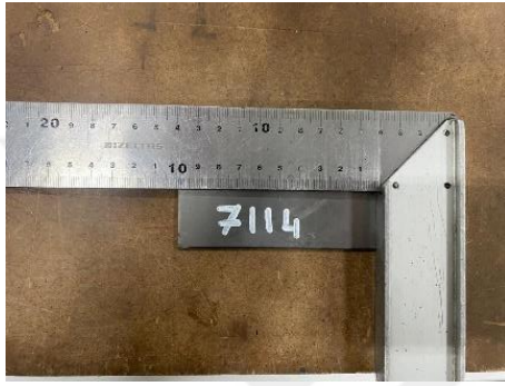
Şekil 4.3. DC04-HRP6222 Sacların 100 mm kesilmesi
