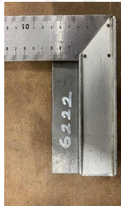
Şekil 4.4. DC04-HRP6222 Sacların 30 mm kesilmesi
