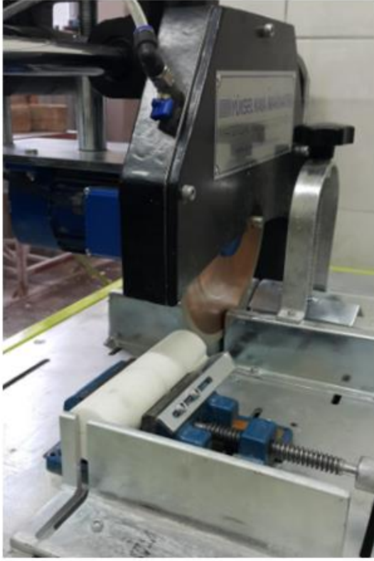
Şekil 4.2. Taş kesme makinesine monte edilmiş mengeneli düzenek.
