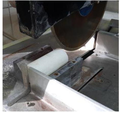
Şekil 4.3. Taş kesme makinesine monte edilmiş V-kanalın genel ve yakından görünümü.
