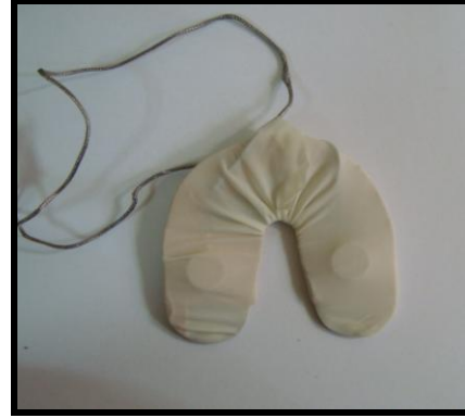
Resim 7. Metal plak üzerine yerleştirilmiş ve latex eldivenle kaplanmış strain- gage transduserlar
