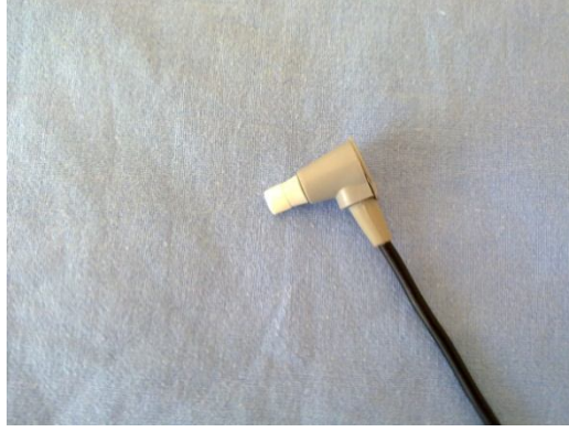
Şekil-7: Çalışmamızda otoakustik emisyon ölçümünde kullanılan yeni doğan probu
