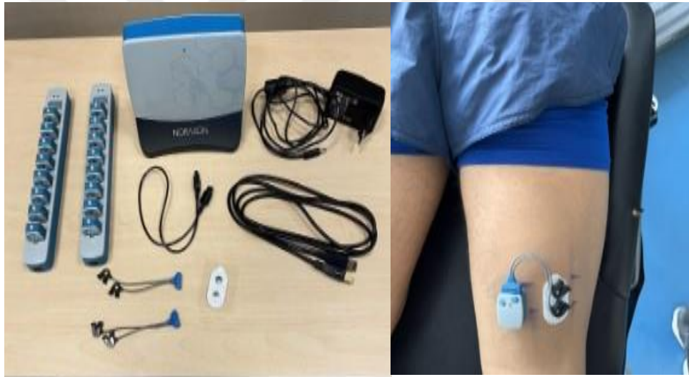
Görsel 3.4. yEMG cihazı ve BF için elektrot pozisyonu
