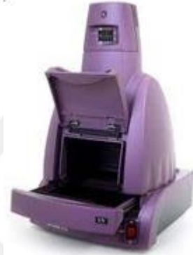
Şekil 3.4. Jel görüntüleme cihazı (Mini, DNR Bio-Imaging Systems, İsrail)
