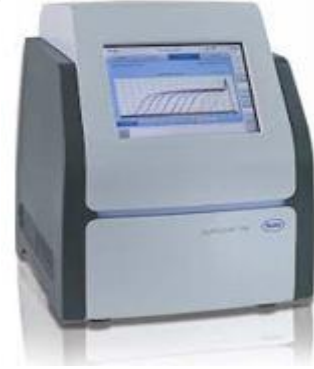
Şekil 3.6. Real-time PCR cihazı, Light Cycler®96 (Roche, İsviçre)
